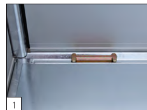
1 Standard: ganci fissaggio carico a scomparsa nel telaio certificati TÜV.
