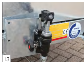
13 Optional: pompa manuale di emergenza in aggiunta alla pompa elettrica.
