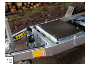
12 Optional: pompa elettrica con batteria, in alternativa alla pompa manuale.
