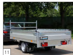
11 Optional: Combi Protect Rail, ringhiera zincata, rinforzata fissaggio carico.
