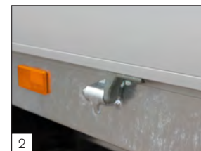
2 Standard: cerniere attacco sponde saldate con ganci fissaggio carico.
