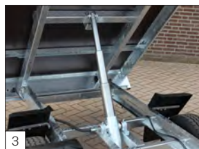
3 Standard: cilindro idraulico a 3 stadi.
