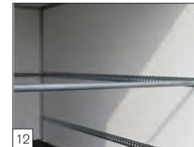
12 Optional: ringhiere ferma carico installate internamente complete di barre di contenimento regolabile.
