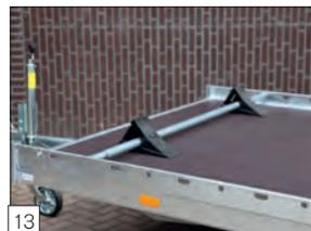
**Optional:** Bloccaruota modello 'Combi Protect Rail' con 2 supporti posteriori regolabili
