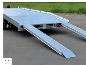
**Standard:** vano rampe integrato sotto il pianale di carico.
