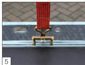
**Standard:** sistema di fissaggio carico certificato TÜV. Ogni punto di fissaggio ha una portata di 1000 kg.
