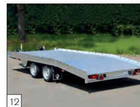
**Optional:** pavimento in profili in alluminio spessore 15 mm anziché in multiplex.
