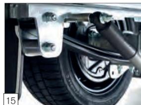
**Optional:** sospensioni paraboliche, balestre ed ammortizzatori per Indigo HF con portata 3500kg. (standard per il modello dimensioni 505x221 cm)
