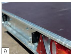
**Standard:** profilo ad U posteriore per il fissaggio delle rampe di carico.
